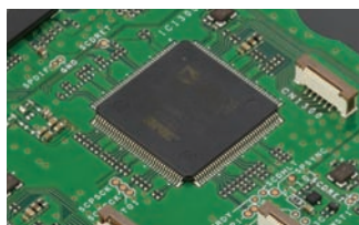
DSP für das Bandspkop ADSP-21363, Takt 332 MHz
