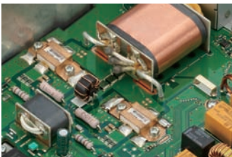
Die beiden Endstufen-MOSFETs RD100HHF1
